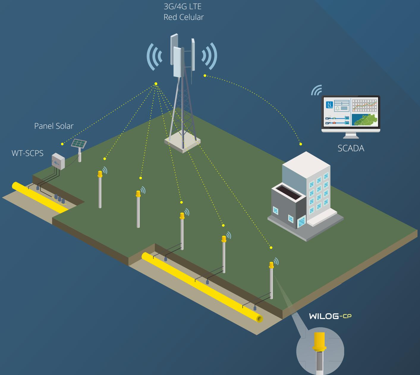
El WILOG-CP es capaz de conectarse a los sistemas SCADA directamente o por nuestro servicio basado en web NOVO Cloud Scada con el fin de enviar información para que automáticamente se ajusten los rectificadores requeridos para lograr el nivel perfecto de protección de toda la tubería. Además, todas las alarmas son enviadas en tiempo real debido a un alto o bajo o una falta de nivel de protección.
