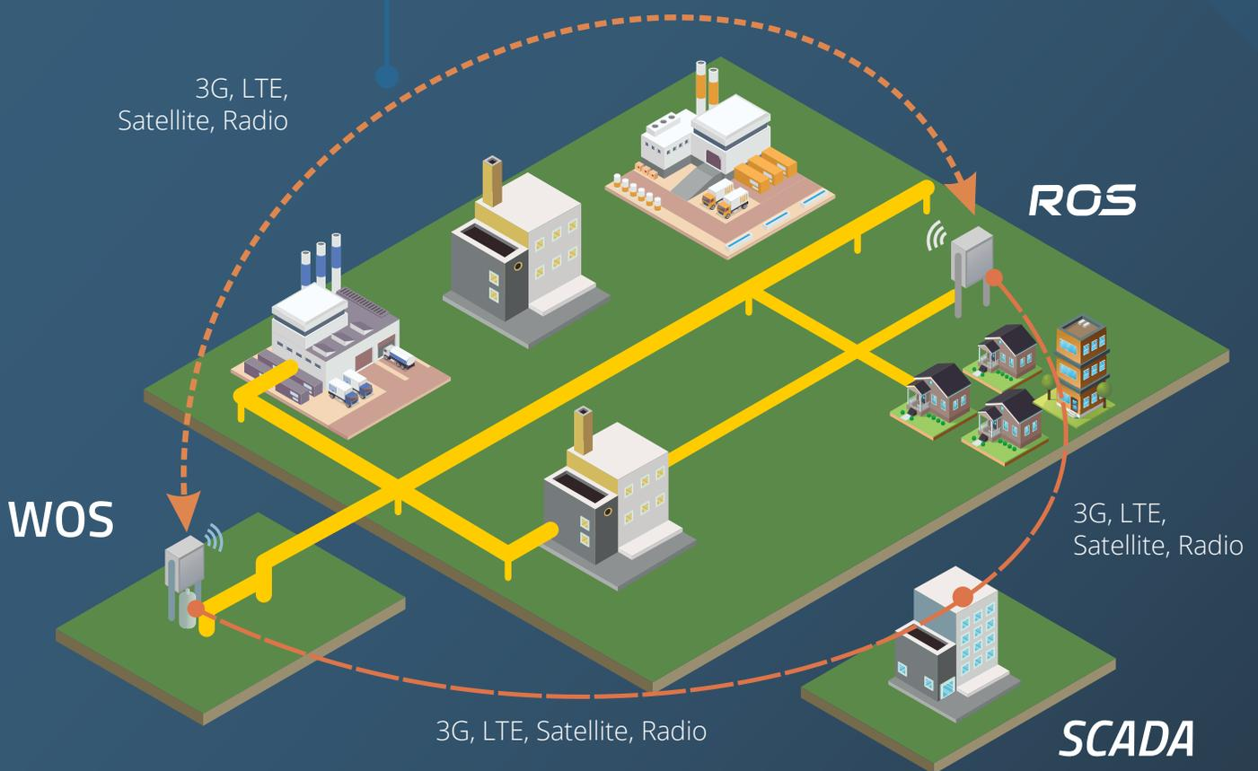
Para operaciones de misión crítica, alarmas en tiempo real son enviadas al Sistema SCADA por bajo nivel de odorante en el tanque, daños en la bomba, bajo voltaje, etc. En caso de daños en la bomba, una segunda bomba de respaldo es activada automáticamente, incluso sin energía, la operación neumática toma control.
